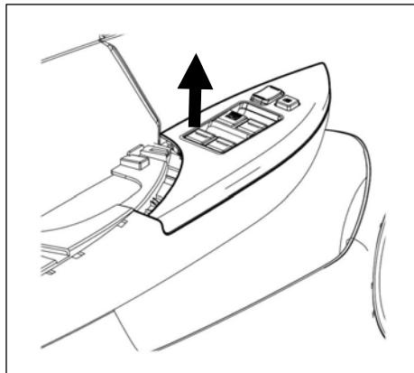
3. 拆卸左前门玻璃升降器开关及装饰板总成。
