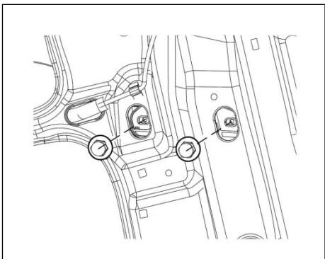
(b) 用 10#套筒拆卸两个固定螺栓。
